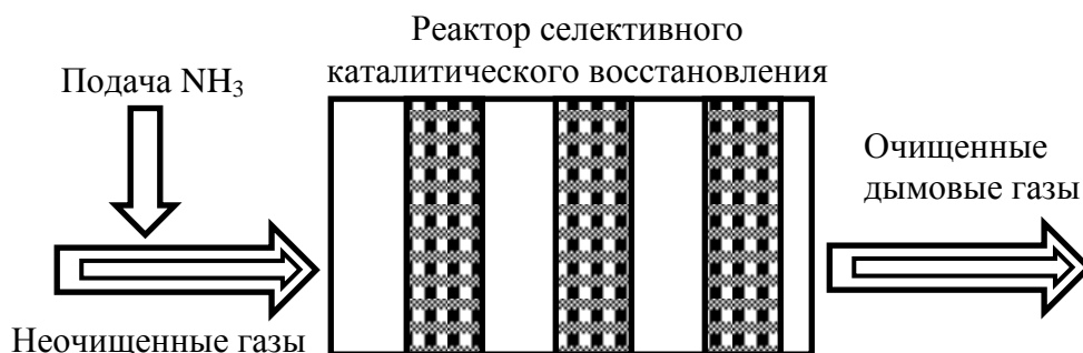
Рис. 3.15. Принципиальная схема работы системы селективного каталитического восстановления (SCR)
